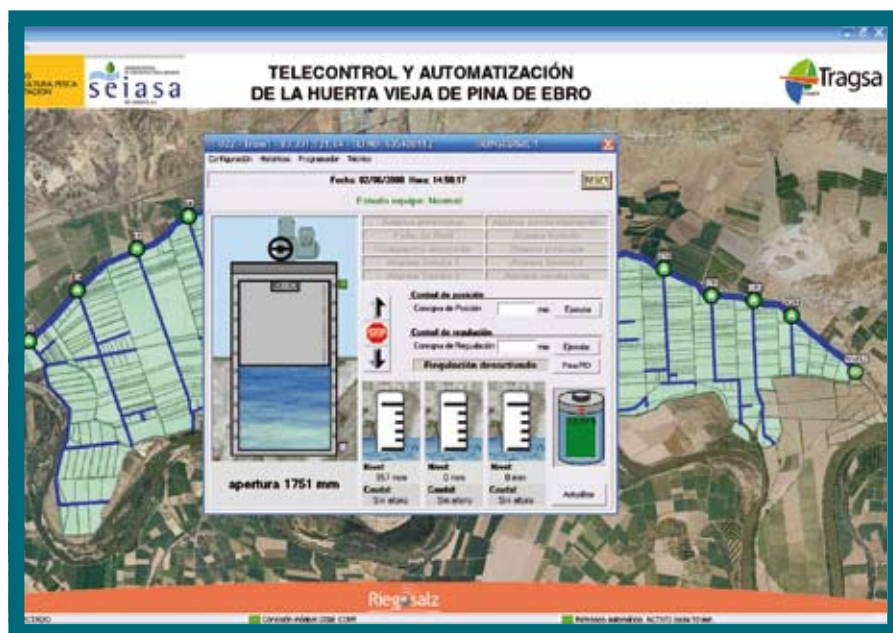
Figura 6. La filosofía del sistema de telecontrol y automatización de Riegosalz permite el control de puntos aislados de forma individual o su integración en sistemas centrales de control.
