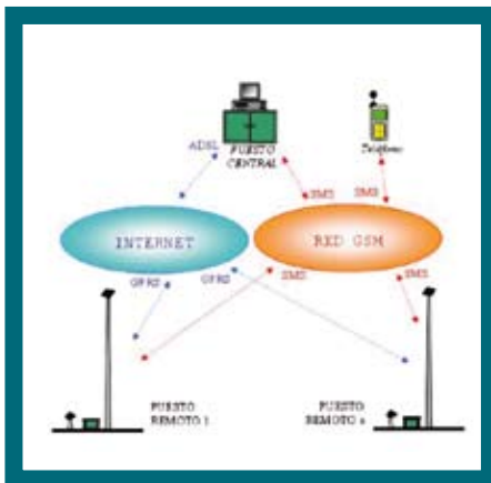
Figura 2. El sistema de comunicación GSM-GPRS permite que cada punto remoto pueda ser controlado de forma individual a través de un teléfono móvil y, a la vez, mantener la conexión con un puesto central de control a través de Internet
